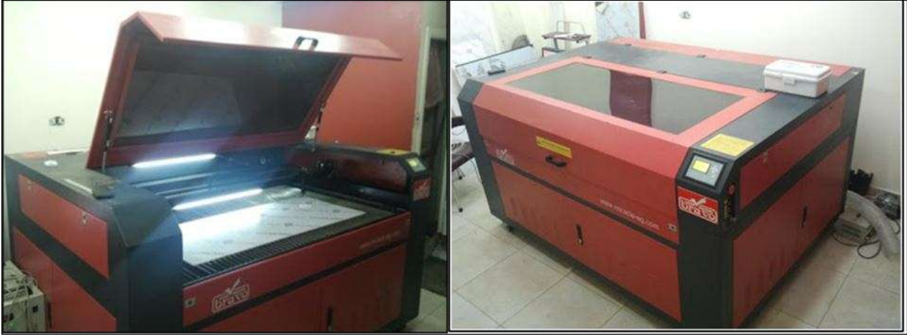
شكل (٤) آلة القص بالليزر بتقنية التحكم DSP، للقص على الأكريليك والخشب والبلاستيك والأقمشة. ( https://www.pngegg.com/en/png-merts )
